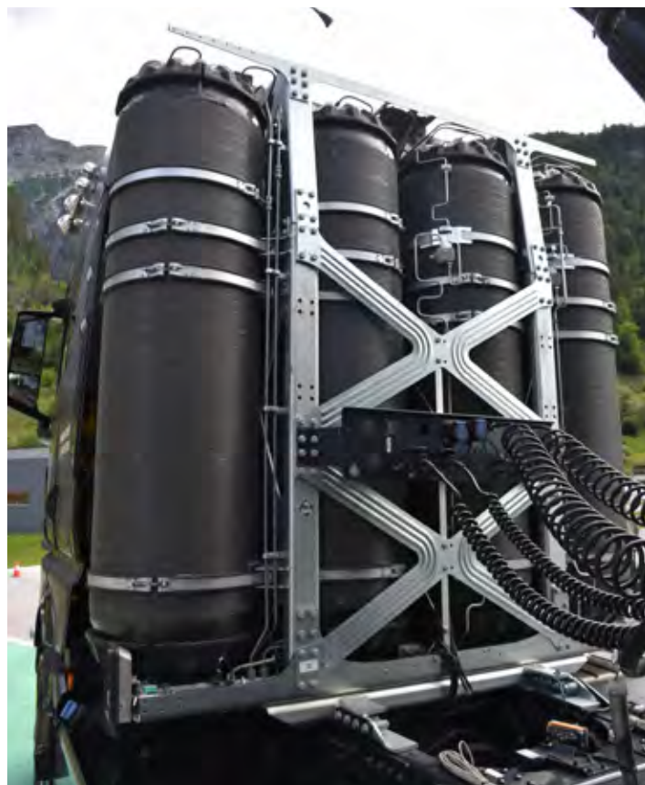
Vodikov hTGX ima štiri rezervoarje za vodik nameščene za kabino. Prve stranke bodo tovornjake prejele že prihodnje leto.
