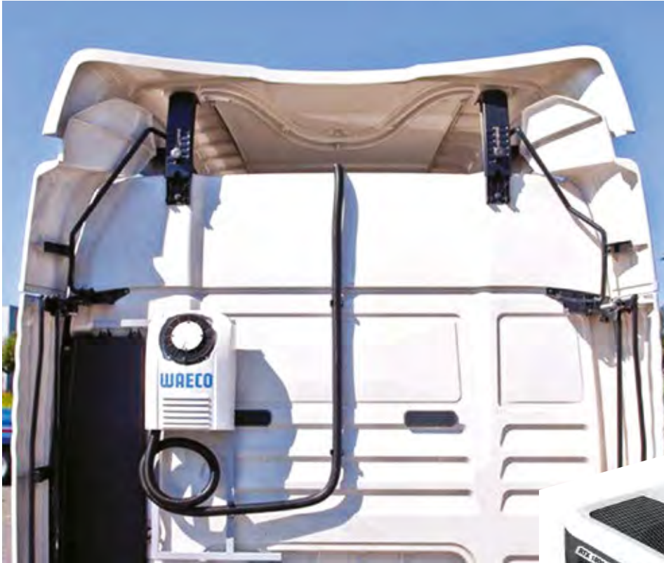
Vgradnja split sistema na zadnjo steno kabine zmanjšuje velikost komponente na strehi.
