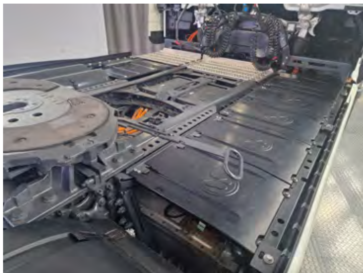
Trije baterijski paketi LFP baterij nameščeni na šasijo nudijo kapaciteto 621 kWh.
