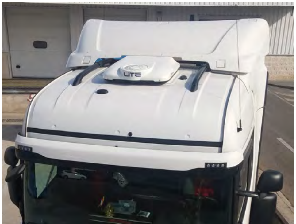
Sistem se napaja z elektriko iz akumulatorja, a se avtomatsko izključi če bi nivo napoljenosti akumulatorja padel pod dovoljen nivo.
