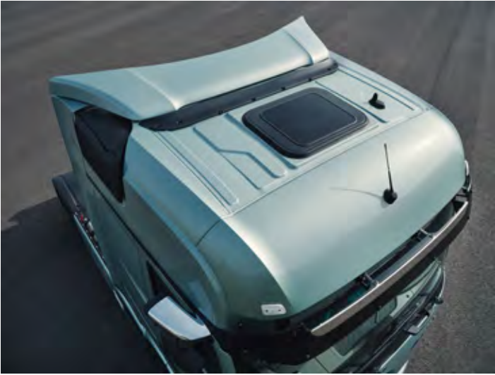
Glavnemu spojlerju na strehi kabine je dodan predspoljer za še boljši pretok zraka.
