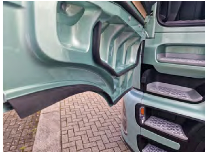
Vratom so dodana tesnila, tretja stopnica pa je preozka, zato bodo vozniki nehote pogosto stopali na blatnik.
