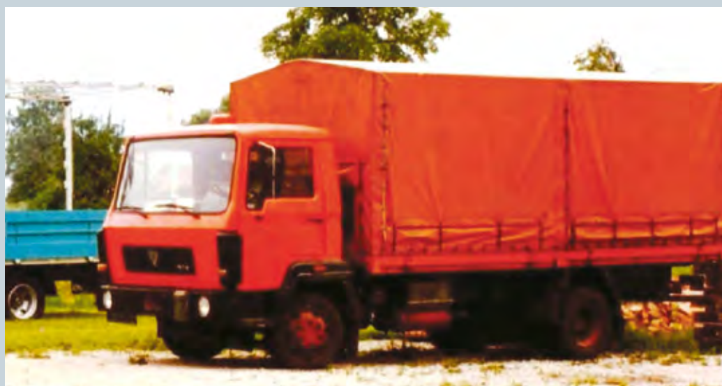
Prekucna kabina novega razreda B je bila dosti sodobnejša od tiste pri zastarelem modelu 80T5, ki je bila fiksna, tako da so motor popravljali od znotraj.
