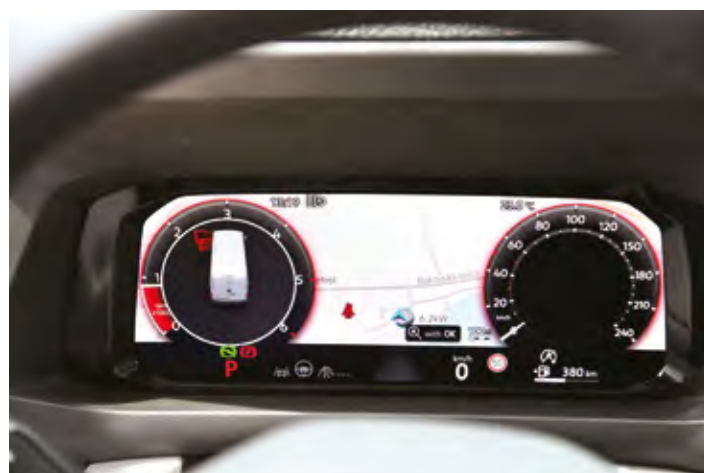
Analogne merilnike nadomešča LCD zaslon, na katerem si voznik lahko prilagodi prikaz podatkov.
