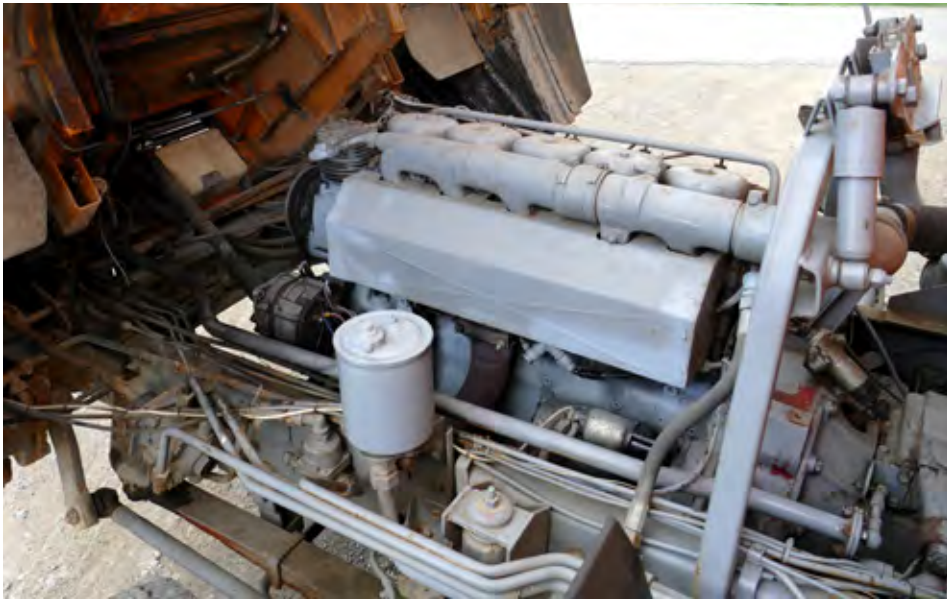
TAM-a 100T8 je poganja Deutzev petvaljni vrstni zračno hlajeni dizelski motor, za katerega v prospektih ni pisalo, da so mu dodali turbinski polnilnik.
