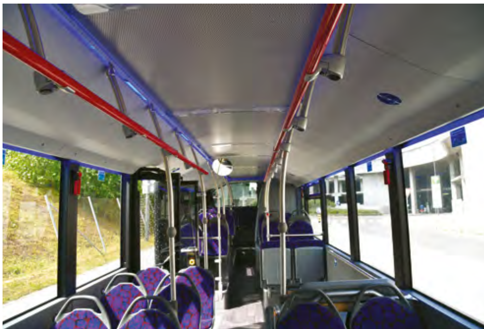
»Motorni stol« v zadku avtobusa je tam ostal še od izvedb s klasičnim motorjem in zavzema prostor za štiri dodatne sedeže. Ambientalna LED osvetlitev je novost v ponudbi.
