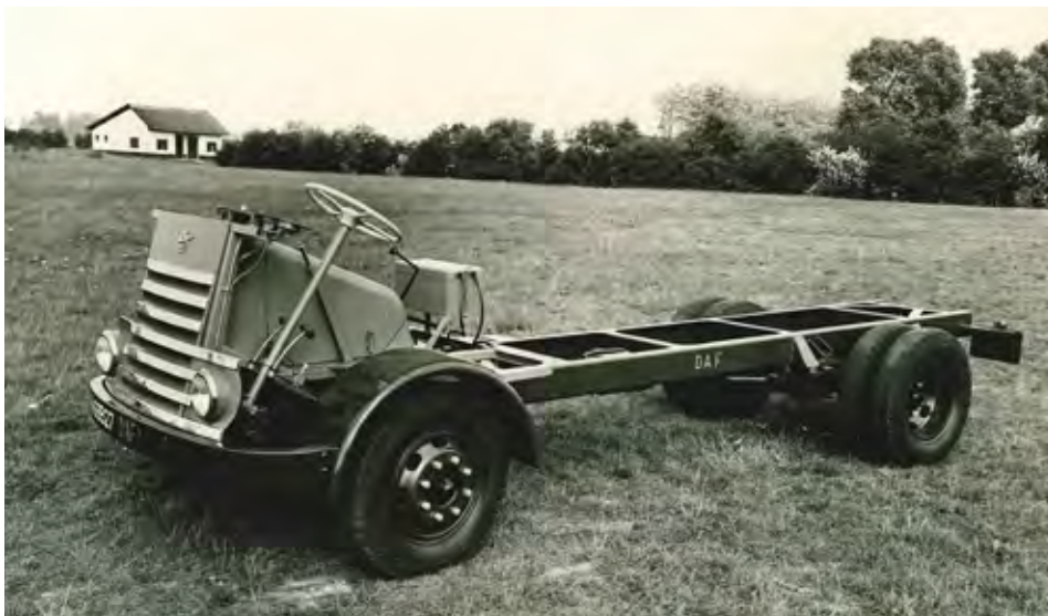
Sprva so iz proizvodnje prihajale šasije z motorjem in masko, a brez kabine - te so izdelovali karoseristi.
