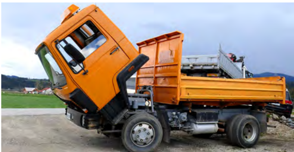
Prekucna kabina novega razreda B je bila dosti sodobnejša od tiste pri zastarelem modelu 80T5, ki je bila fiksna, tako da so motor popravljali od znotraj.
