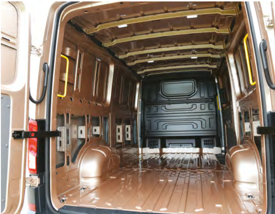
Tovorni prostor je osvetljen z LED lučmi ter pri vratih opremljen z držali za lažje vstopanje.
