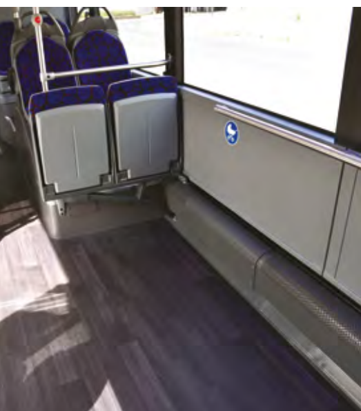
»Motorni stol« v zadku avtobusa je tam ostal še od izvedb s klasičnim motorjem in zavzema prostor za štiri dodatne sedeže. Ambientalna LED osvetlitev je novost v ponudbi.
