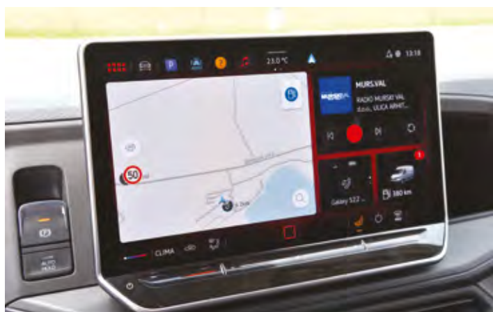
Velik osrednji zaslon je hitro odziven ter opremljen z bližnjicami za najbolj pogosto uporabljene funkcije, pod njim pa so drsniki za upravljanje s temperaturo in glasnostjo.
