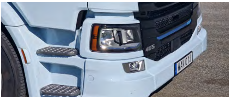
Scania je nove evropske predpise glede večjih dimenzij izkoristila z manjšim »aerodinamičnim« podaljškom sprednjega odbijača.
