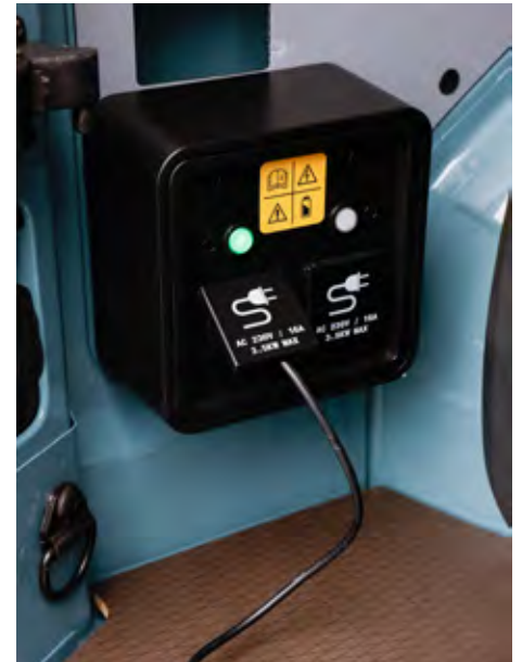
V tovornem delu električnih izvedb je lahko priključek moči 3,5 kilovata za napajanje orodja.
