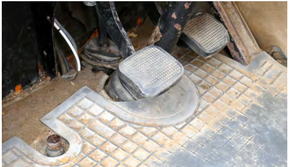
Osemtonec je med drugim imel motorno zavoro (okrogel gumb levo od pedala sklopke (slednji je bil v »našem« primeru telo trd).
