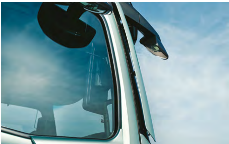
Na A-stebričku, pri vetrobranskem steklu, je nameščen dodaten usmerjevalec zraka.
