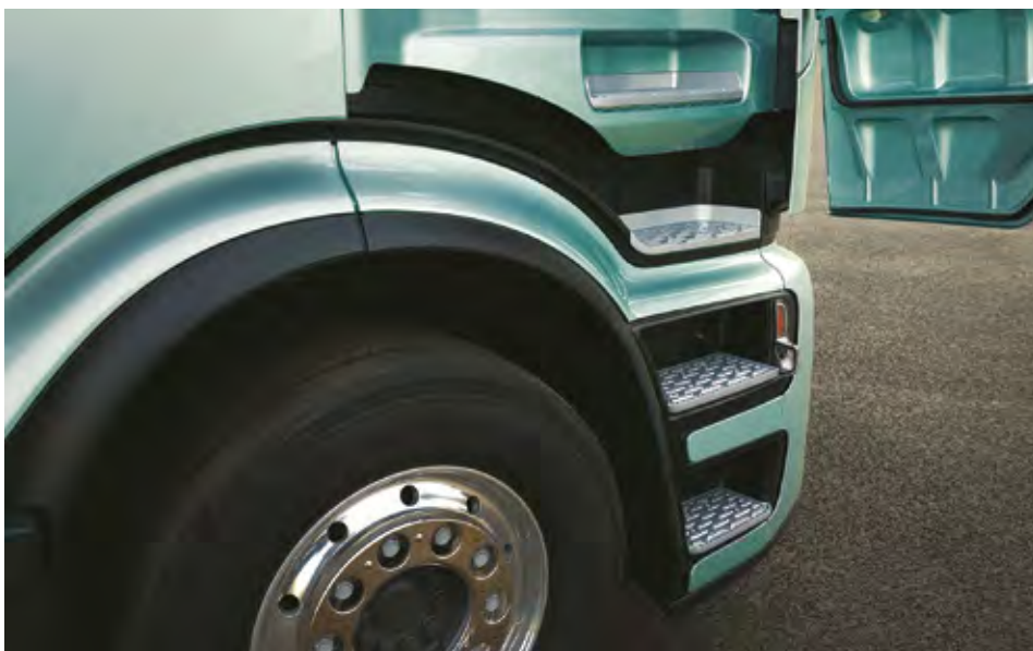
Spodnji del vozila je podaljšan za 80 milimetrov in aerodinamično oblikovan.
