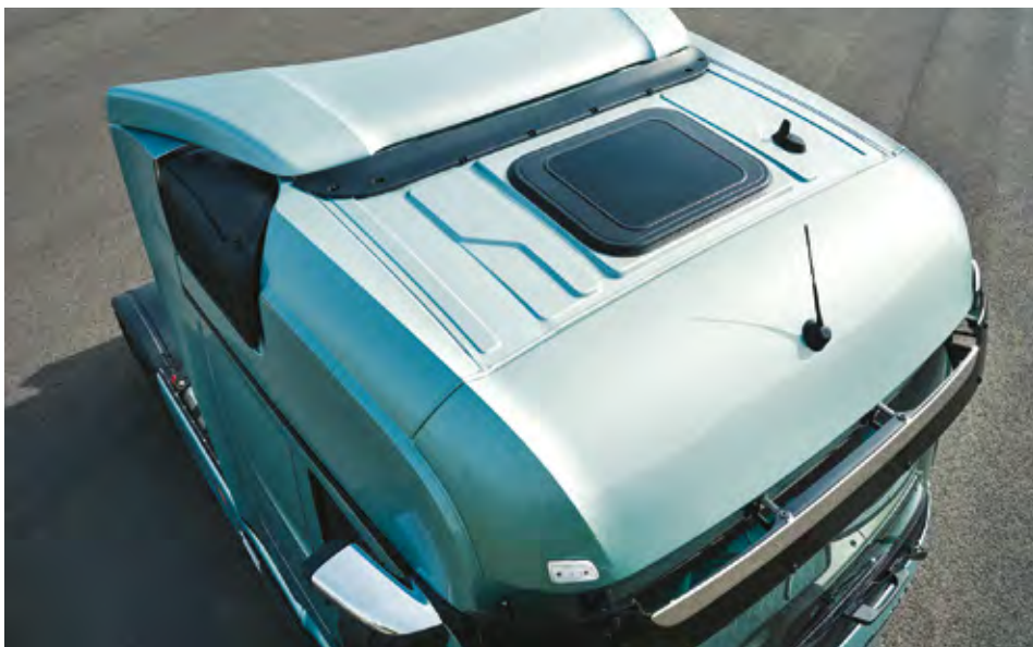
Na strehi kabine je novost manjši usmerjevalec zraka pred glavnim strešnim spojlerjem.
