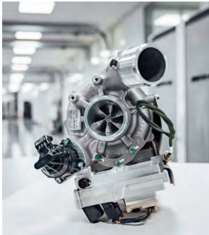
Pri turbo polnilniku je zamenjan rotor kompresorja, obdelane so notranje stene ohišja in robovi za dobro tesnjenje, zamenjano ali obnovljeno je tudi ležajno ohišje.
