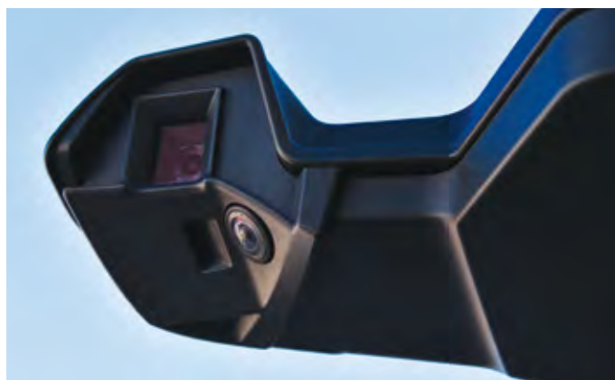
Po dve kameri sta nameščeni na vsakem nosilcu – zgoraj navadna in spodaj širokokotna.
