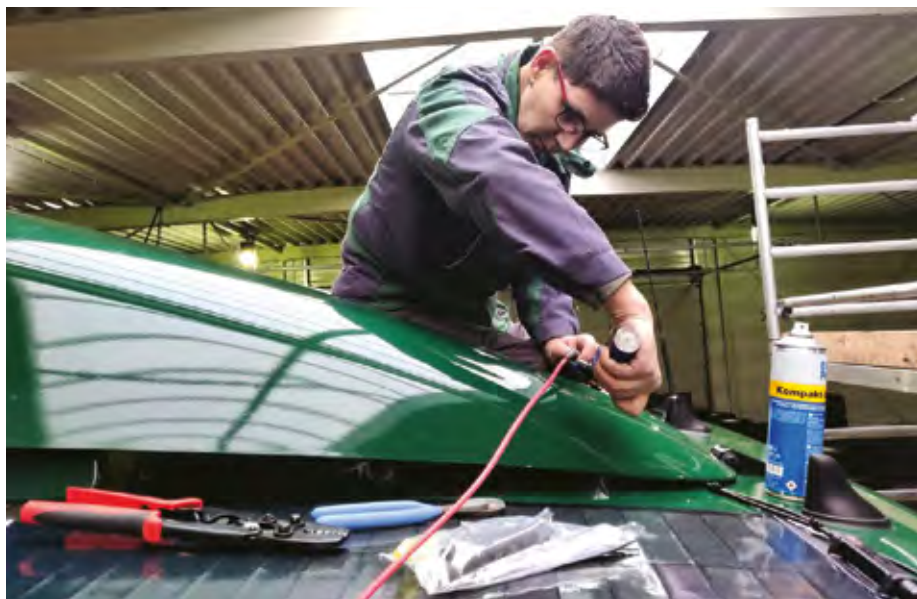
Ker so celice fleksibilne, se preprosto, v delavnici podjetja, vgradijo na streho kabine ali strešne usmerjevalce zraka.
