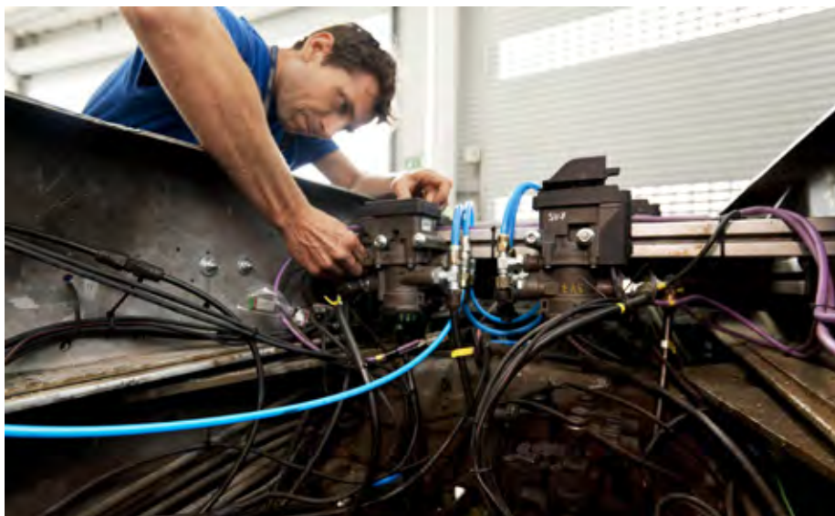
Zračni sistem, poleg osnovnih zavornih tokokrogov 1 in 2, napaja tudi nekatere pomožne uporabnike, kot je zračno vzmetenje, vzmetenje sedeža, hupe,...
