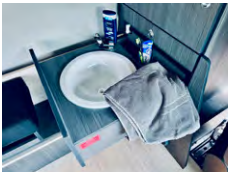
Izvlačni lijak se napaja iz rezervoarja s čisto vodo.
