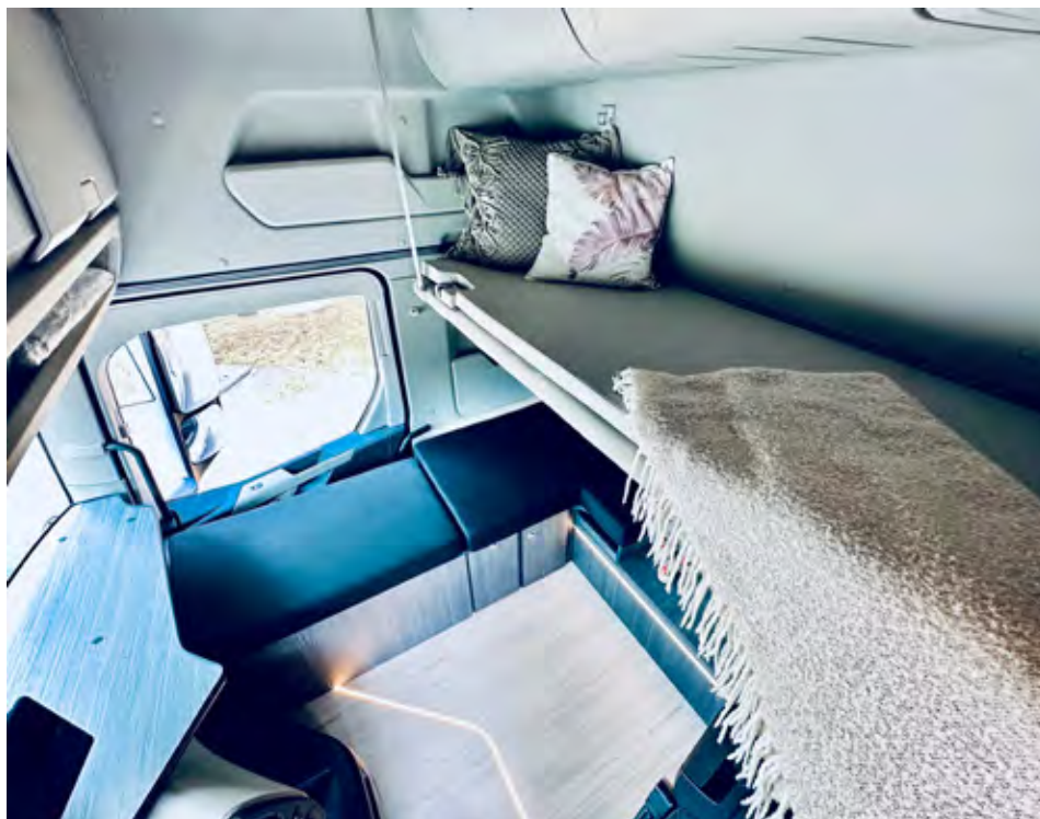
Dodatni prostor zaradi le enega sedeža je izkoriščen za velik oblazinjen sedalni del pod katerim so lesene shranjevalne omarice. V vgrajene elemente je integrirana LED razsvetljava.
