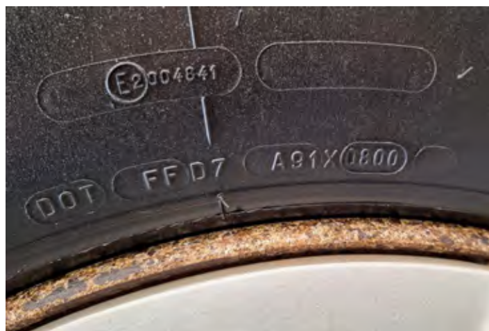
Pnevmatike na pogonski osi so izdelali v osmem tednu leta 2000.
