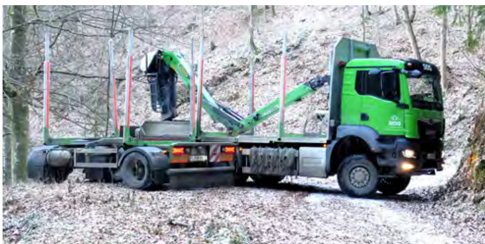
Vozniki gozdarskih tovornjakov več kot 16-metrsko kompozicijo obrnejo na 10-metrski razširitvi ceste.
