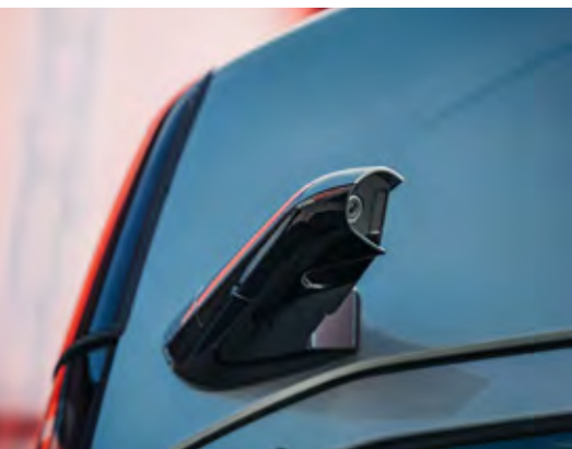
Kamere so vgrajene na zložljive aerodinamične nosilce.
