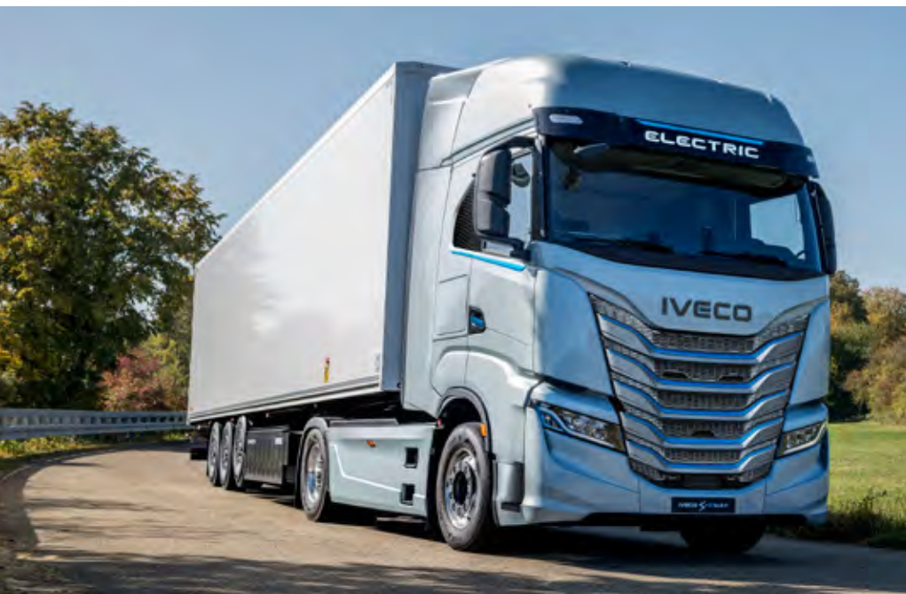
Električni S-eWay s 738 kWh baterijami bo ponujal ta hip največji doseg med električnimi tovornjaki za prevoze na dolge razdalje.
