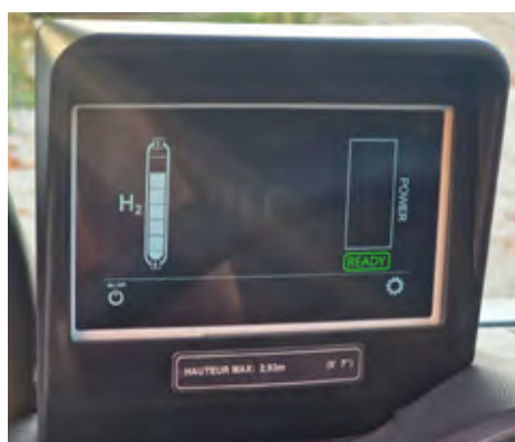
Dodaten zaslon na armaturi prikazuje delovanje sistema in napolnjenost rezervoarjev z vodikom.
