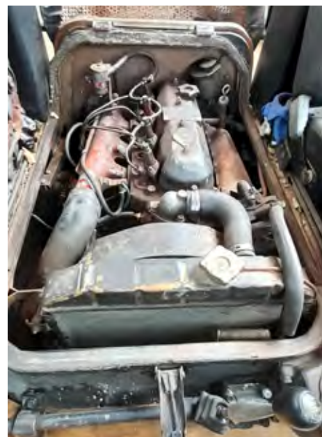
Za pogon skrbi 2,5-litrski atmosferski dizelski motor, ki razvije 'le' 75 konjičkov.
