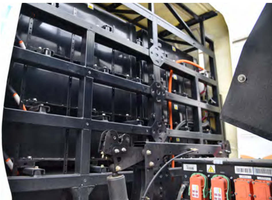
Baterijski moduli so nameščeni eden nad drugim v dveh stolpcih za kabino.
