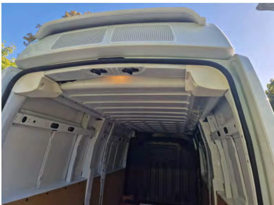
Gorivna celica in rezervoarji z vodikom so vgrajeni v strehi, zato je nekoliko manjša nakladalna višina tovornega prostora.
