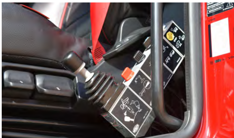
Prekucnik je mogoče upravljati tudi s klasičnim komandnim modulom ob vozniškem sedežu.
