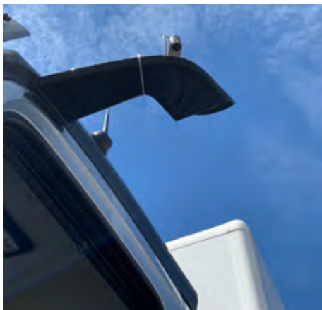
Tovornjaki so opremljeni z dodatnimi kamerami za spremljanje okolice.
