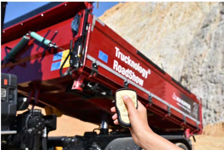
Praktičen brezžični daljinski krmilnik omogoča upravljanje s prekucno nadgradnjo iz zunanosti kabine.
