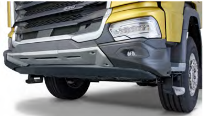
Tridelni jekleni odbijač, globoko vanj pomaknjene meglenke in jeklena zaščitna plošča ščitijo pred poškodbami.
