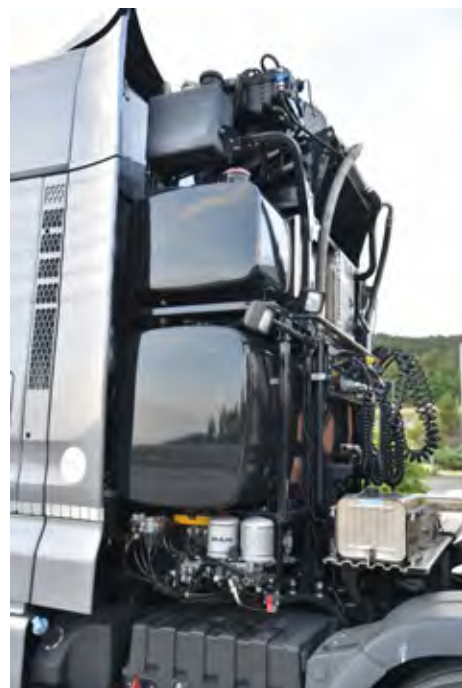
Specialni vlačilec MAN TGX s 640 konjskimi močmi je opremljen s tako imenovanim stolpom za kabino, kjer so nameščeni rezervoarji za gorivo, ter zmogljiv hladilni sistem hidravlike.
