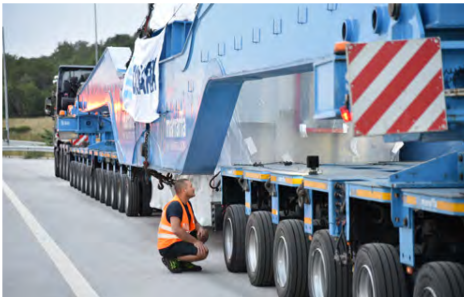
Transformator je bil vpet v mostni nosilec nameščen na modularno prikolico. Uravnavanje višine na čim nižjo možno je pomembno za zagotavljanje nizkega težišča in s tem povezane varnosti.
