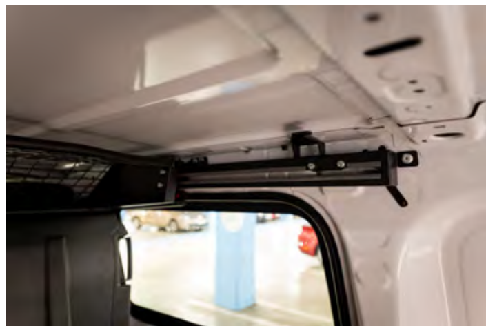
Z eno potezo se klop skupaj s pregradno mrežo pomakne naprej in ponudi tovoru nekaj dodatnega prostora.
