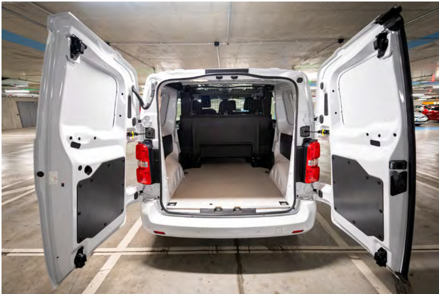
Široka odprtina vase sprejme malo manj kot tono tovora. Potnike pred naletom tovora varuje kovinska mreža.
