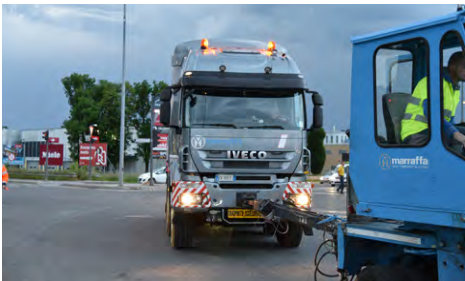
Za potiskanje je na koncu kompozicije skrbel Iveco Trakker s 13 litrskim motorjem in 560 konjskimi močmi.
